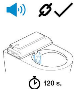
**ES** Desde el instante en que se enchufa el aparato a la red (2), se dispone de 60 segundos para sincronizar el mando. Para sincronizar el mando (3), presionar simultáneamente los botones Secado y Paro/Stop del mando durante 5 segundos hasta que se escuche un beep y se encienden todos los LED del mando. A partir de ese momento se inicia un proceso de auto-calibración del aparato (4) que dura 120 segundos, durante el cual sale agua por la ventana de la cánula del e-bidet.
