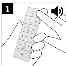
> Drücken Sie die Plus-Taste, um die Duschstrahlintensität zu erhöhen.
