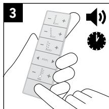
> Druk op Stop om de functie Bidet te beëindigen. Na 2 min. wordt de automatische stopfunctie geactiveerd.
