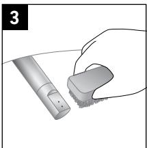
> Reinigen Sie die Düse mit einem Tuch, einem Schwamm oder einer Bürste und einem milden Reinigungsmittel.
