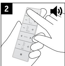
> Drücken Sie die Minus-Taste, um die Duschstrahlintensität zu senken.
