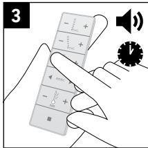
> Druk op Min om de Comfortdouche uit te schakelen. De functie (Bidet of Lady-douche) die voorheen was ingesteld, is nog steeds ingeschakeld. Na 2 min. wordt de automatische stopfunctie geactiveerd.
